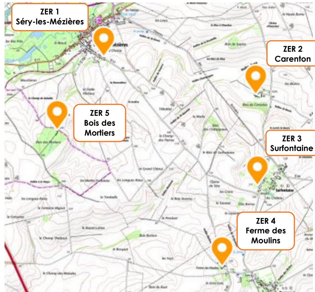
Figure 1. Implantation des points de mesures de bruit résiduel
